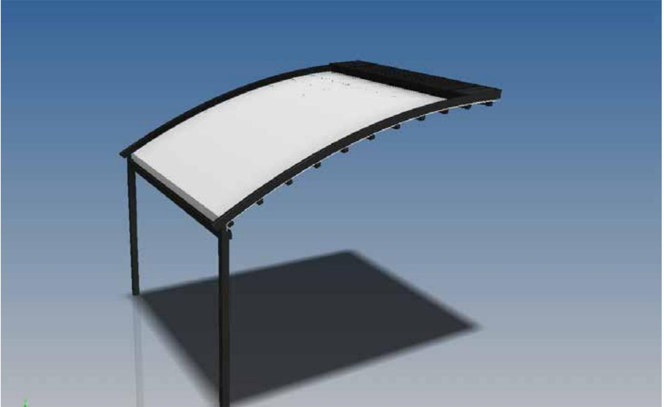
E' una struttura semplice e lineare, con un profilo tondeggiante per darle un effetto di morbidezza. Interamente realizzata con profili in alluminio verniciato e con coperture in PVC oscurante pretensionato, o in PVC Valmex oscurante gofrato oppure in PVC Opatex bicolore, la struttura è addossata e movimentata da un motore elettronico radiocomandato, che permette l'apertura a impacchettamento del telo fino alla massima tensione.
