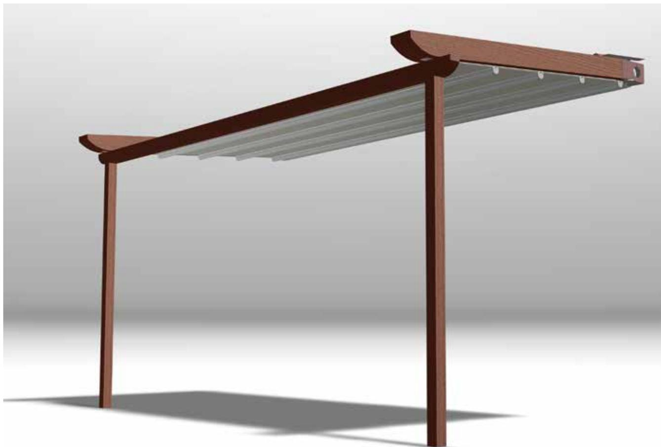
Pergola in alluminio rivestito in legno di abete impregnato a pressione in autoclave con l'utilizzo di sali ecologici privi di cromo ed arsenico (omologati dai principali istituti europei), con ulteriore colorazione tramite nobilitazione a base di impregnanti ad acqua, completa di tenda apribile ad impacchettamento (con telo teso a tenda aperta).
