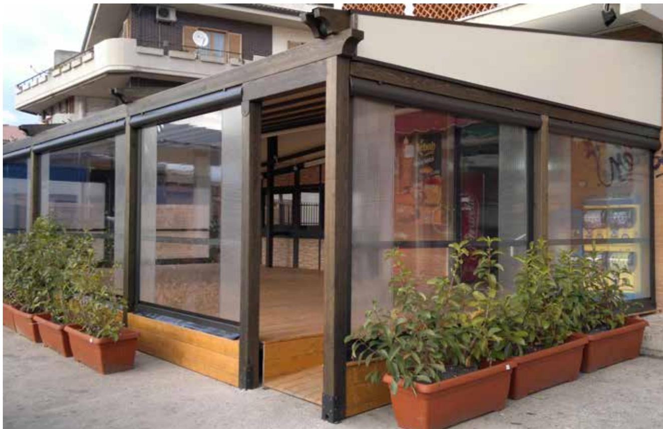
Pergola in alluminio rivestito in legno di abete impregnato a pressione in autoclave con l'utilizzo di sali ecologici privi di cromo ed arsenico (omologati dai principali istituti europei), con ulteriore colorazione tramite nobilitazione a base di impregnanti ad acqua, completa di tenda apribile ad impacchettamento (con telo teso a tenda aperta).
